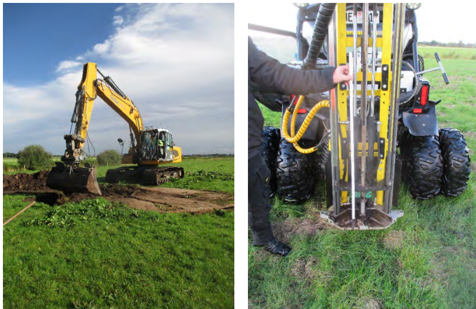
Abbildung 6: Untergrunderkundung mit Kettenbagger und Quad
