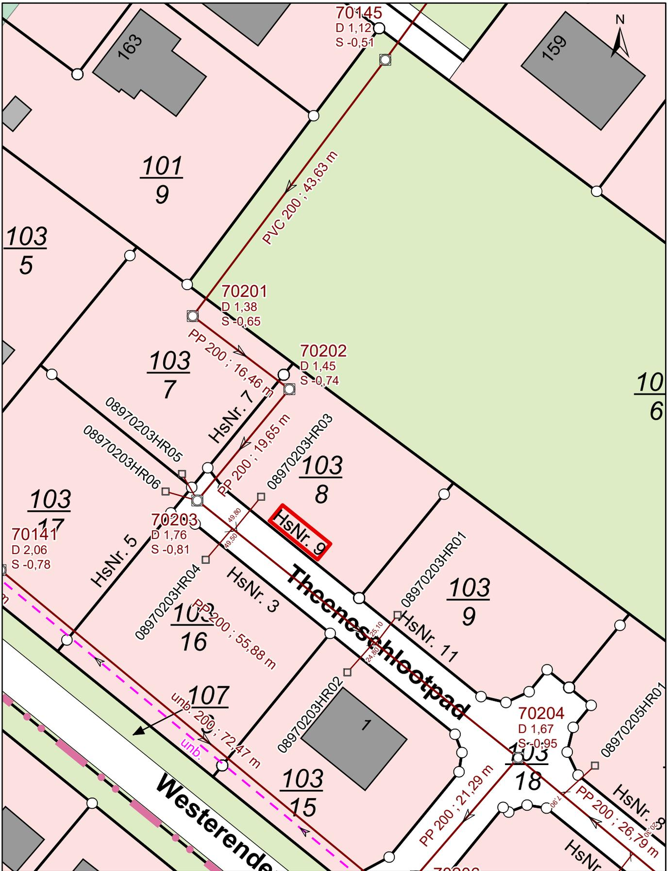
Die in den Plänen enthaltenen Eintragungen hinsichtlich der Leitungslage und -tiefe sind unverbindlich. Die genaue Lage der Leitungen ist durch Querschläge in Handschachtung festzustellen. In Leitungsnähe sind die Erdarbeiten unbedingt von Hand, mit äußerster Vorsicht und nach vorheriger Absprache mit der zuständigen Betriebsstelle des OOWV durchzuführen.
